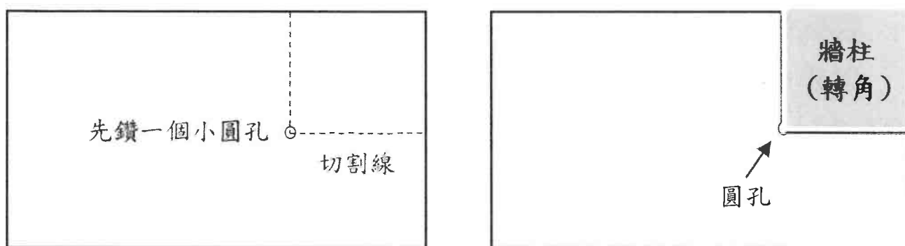
圖 56 圓形鑽孔法之示意圖
